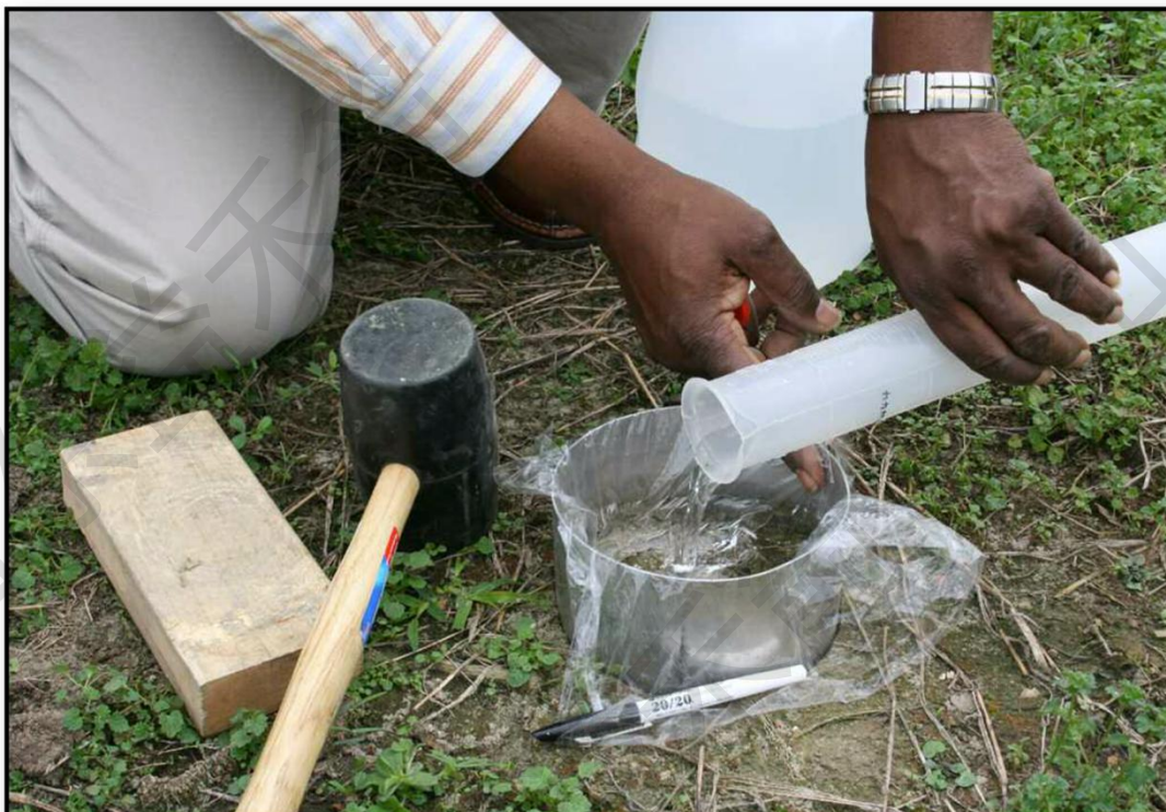
向 6 直径英寸的环中加入 1 英寸的水，测定渗透率
